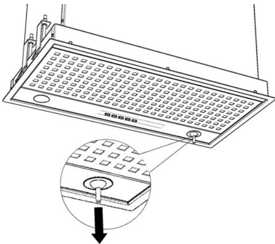
Une ventouse est fournie avec la hotte pour faciliter le retrait des lampes. Placez la ventouse sur la lampe halogène et tirez celle-ci vers vous. La lampe se dégage de son support. Vous pouvez également installer la nouvelle lampe à l'aide de la ventouse.
