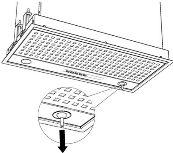
Bij de afzuigkap is een zuignapje geleverd voor het verwijderen van de lampen. Plaats het zuignapje op de halogeenspot en trek deze naar u toe. De lamp komt er nu uit. De nieuwe lamp kunt u ook met het zuignapje plaatsen.
